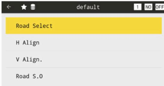
Program Jalan dalam sistem A1, hitung target sebagai kurva komposit yang mungkin termasuk unsur garis lurus, transisi kurva dan kurva melingkar. Sistem akan mempertaruhkan keluar jalan yang dirancang berdasarkan tumpukan angka dan nilai deviasi
